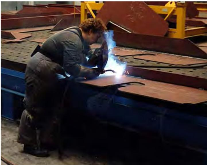
Gemessene Schweißrauchkonzentration an diesem Arbeitsplatz:  $17.900 \mu\text{g}/\text{m}^3$  – **30 mal mehr als in der Disco!**
